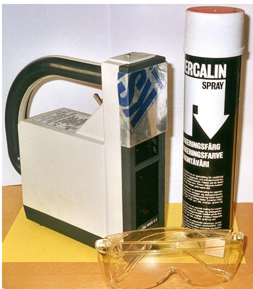
Bild 2 Utrustning för indikering av tjära (UV-lampa + färg).
