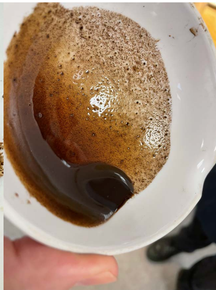
Olja på behandlad lignin (upplösbar i olja)
