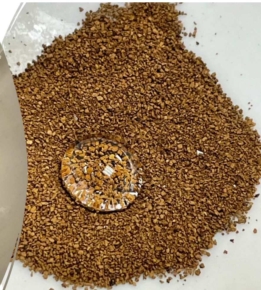
Vatten på behandlad lignin (stöter ifrån sig vatten)
